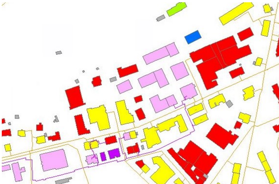
Abbildung 4: Visualisierung der Heizungssysteme von Gebäuden und die dazugehörigen Gas- bzw. Fernwärmeleitungen (rosa: Fernwärme, rot: Heizöl, gelb: Gas, grau: unbeheizt, violett: Umweltwärme, blau: Elektroheizung, grün: Holzheizung)
